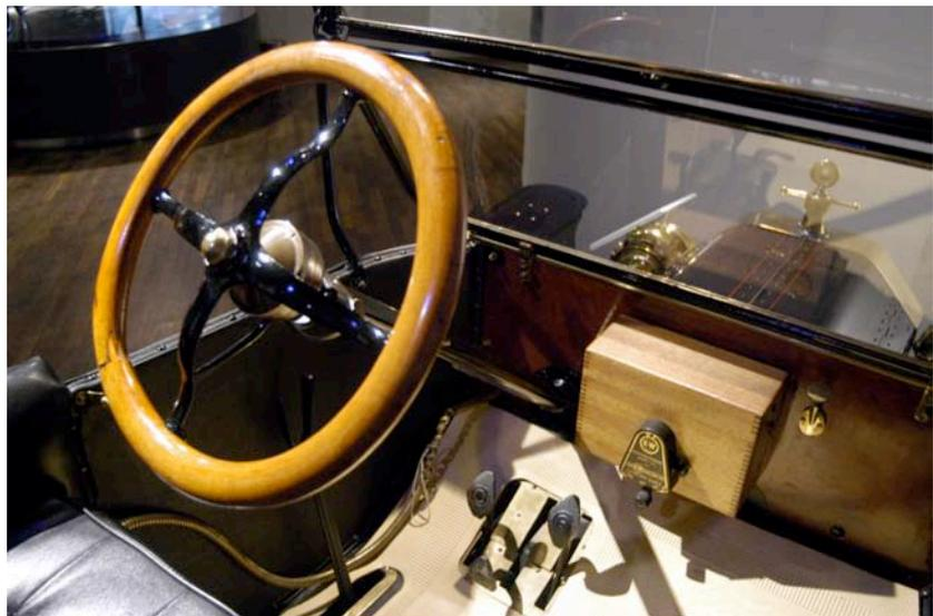
Fußhebels betätigt daraufhin den ersten Gang – das Fahrzeug setzt sich mit etwas Handgas in Bewegung. Langsames komplettes Loslassen des linken Fußpedals legt den großen Gang ein, der über den Handhebel links vorn in dessen vorderer Position sozusagen voreingelegt war.
